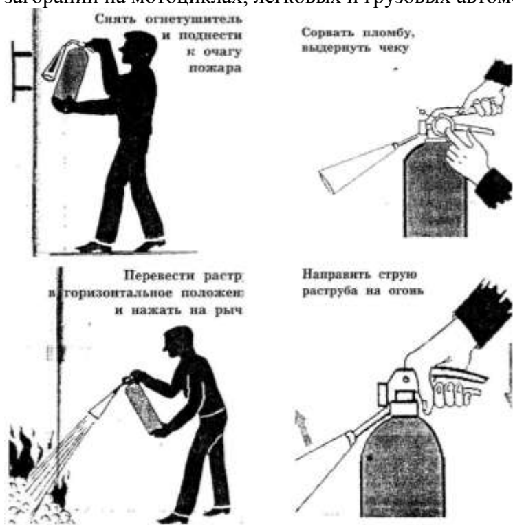
Рис. 3. Приведение в действие ручного углекислого огнетушителя.
