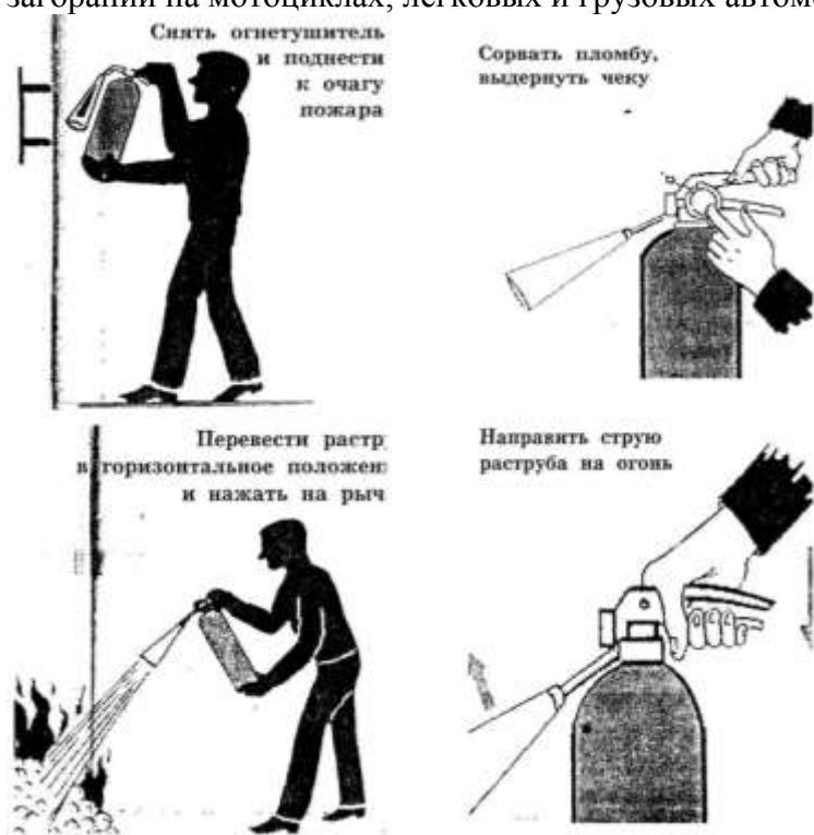
Рис. 3. Приведение в действие ручного углекислого огнетушителя.
