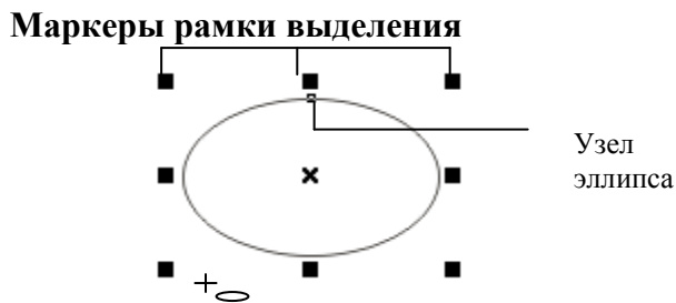
Указатель мыши для инструмента Ellipse (Эллипс) Рис.2. Выделенный эллипс, элементы рамки выделения.
