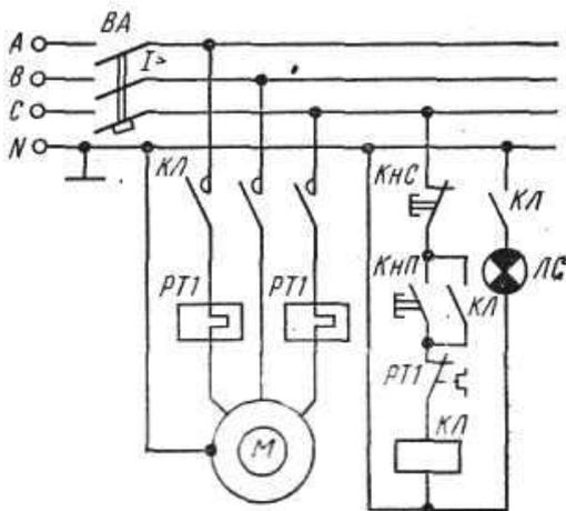
тем, что срабатывает при строго определенном величине и замыкает либо размыкает ту или иную цепь. Реле бывают тепловые, и электрические; последние срабатывают от чин. Реле маркируют двумя буквами: первая указывает его назначение или тип. Например, е напряжения, РР — мощности, РУ — и т. д.
