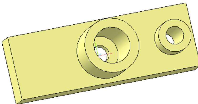
Рисунок 24 – Вид модели детали «Опора» после создания отверстий
