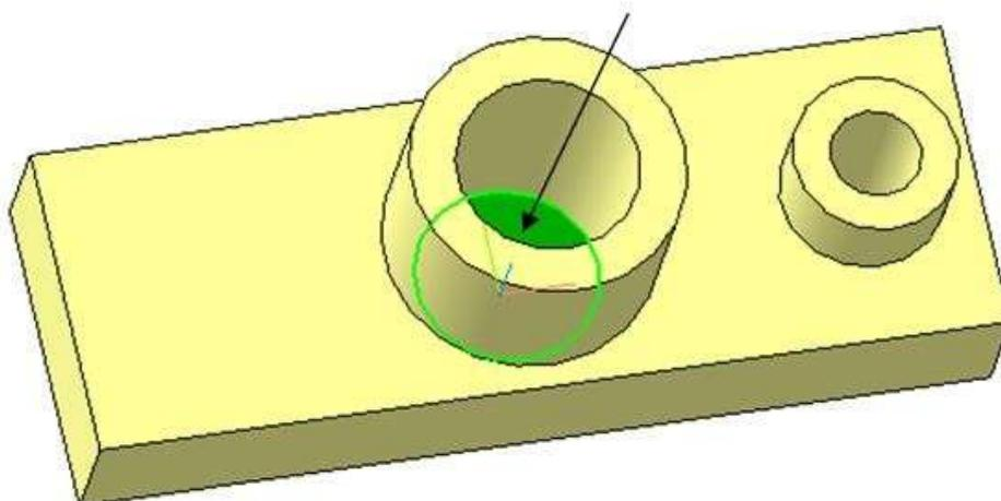
Рисунок 23 – Назначение плоскости для эскиза на глубине 30 мм
