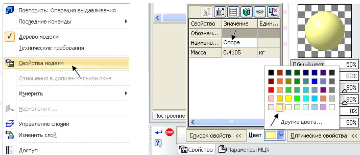
Рисунок 9 – Изменение свойств и цвета детали
