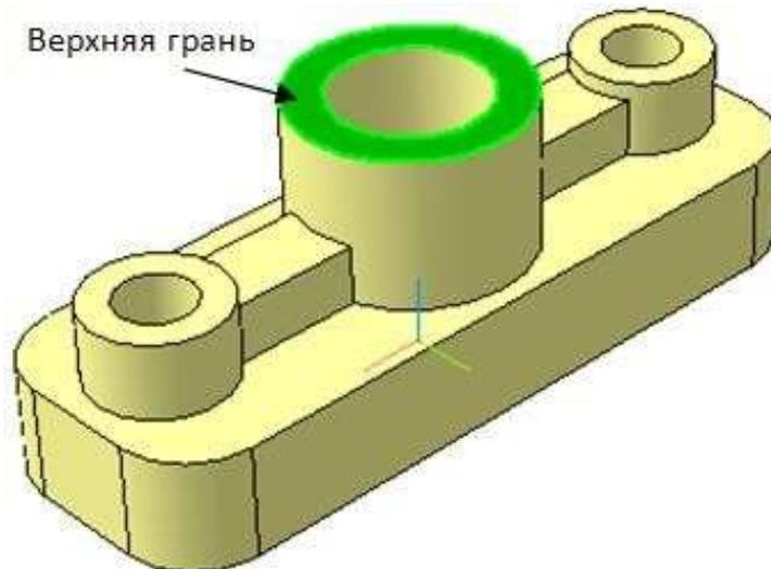
Рисунок 34 – Указание плоскости для выполнения эскиза сечения
