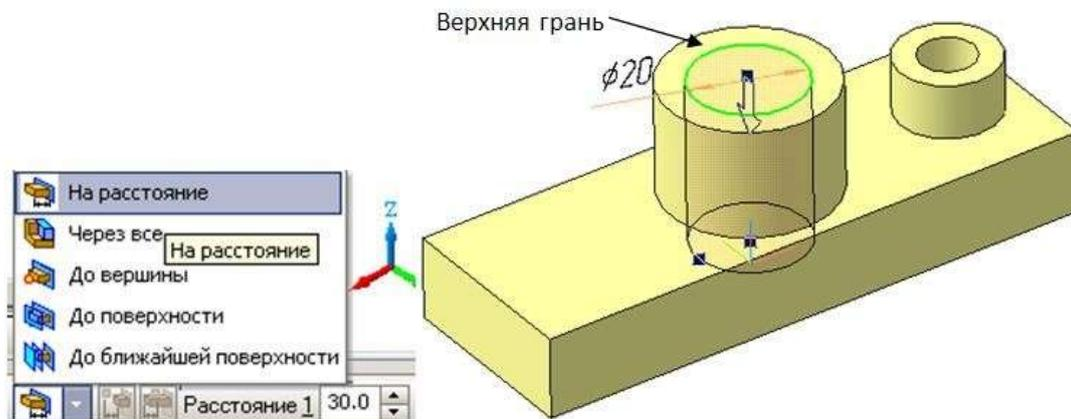
Рисунок 22 – Создание отверстия диаметром 20 мм в центральной бобышке
