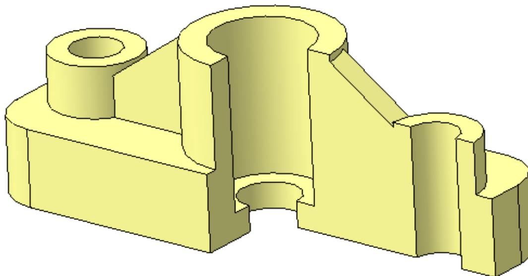
Рисунок 41 – Модель детали «Опора» с измененными ребрами жесткости
