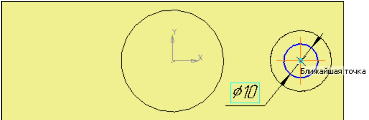
Рисунок 18 – Построение эскиза отверстия диаметром 10 мм
