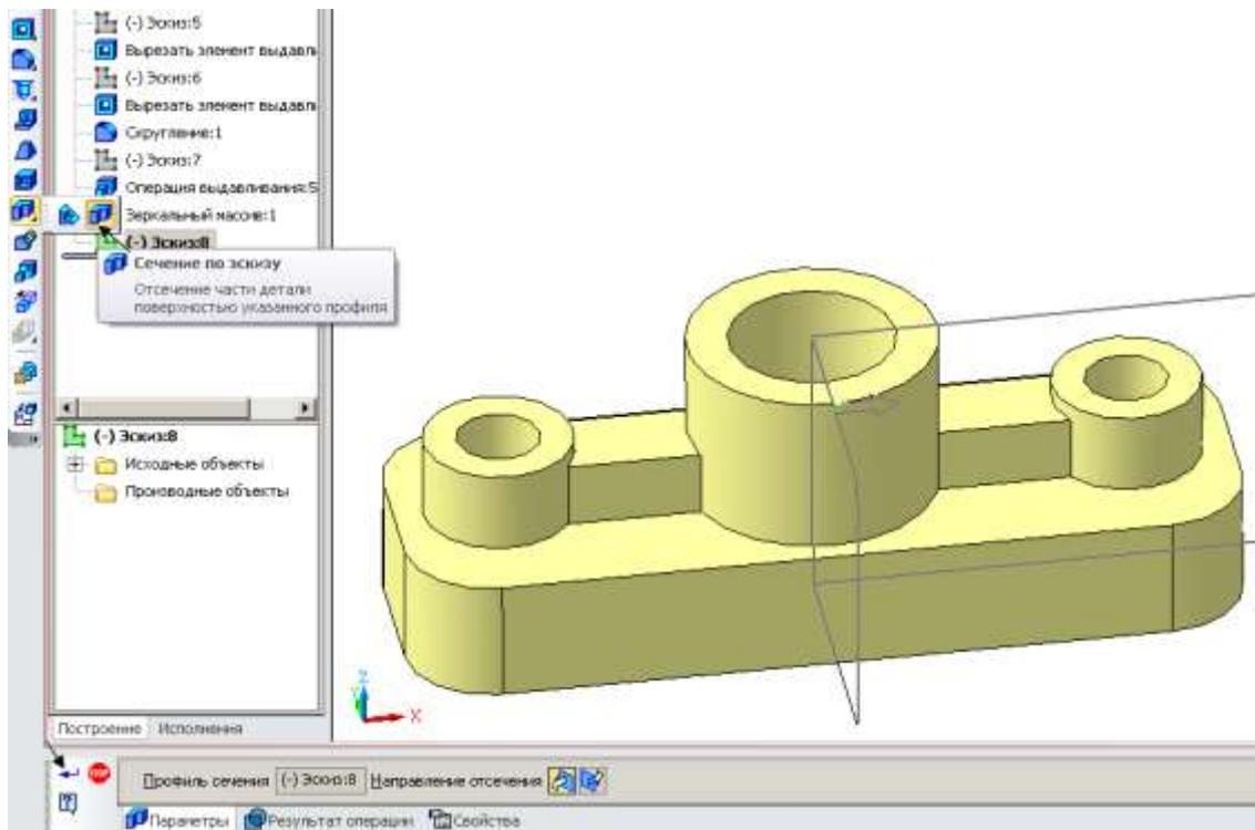
Рисунок 36 – Вид эскиза сечения в системе трехмерных построений
