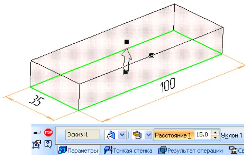
Рисунок 7 – Вид модели после введения параметров формообразования
