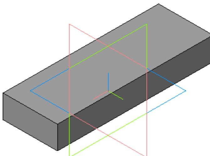
Рисунок 8 – Объемная модель основания детали «Опора»
