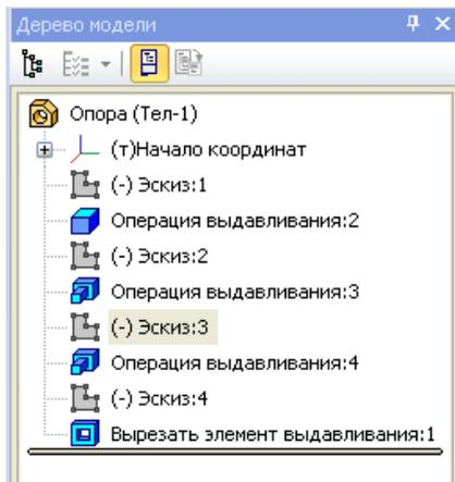
Рисунок 20 – Элемент в дереве модели **Вырезать элемент выдавливания: 1**
