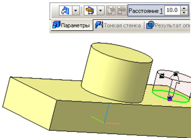
Рисунок 16 – Введение параметров для создания бобышки
