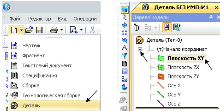
Рисунок 2 – Создание эскиза в окне 3D-моделирования
