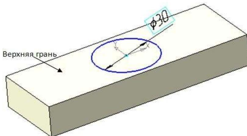
Рисунок 10 – Вид модели с эскизом центральной бобышки
