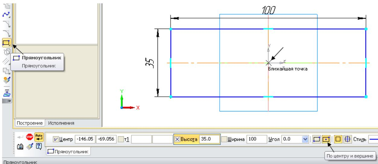
Рисунок 4 – Построение контура основания с помощью команды **Прямоугольник**
