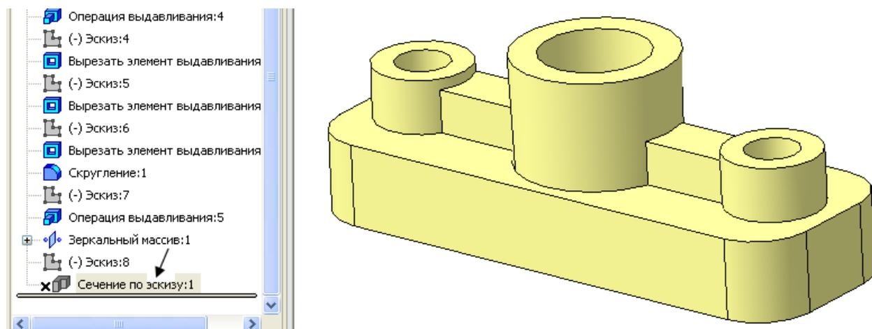
Рисунок 39 – Результат операции *Исключить из расчета*
