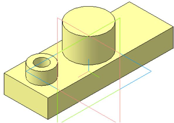
Рисунок 21 – Вид модели после вырезания отверстия диаметром 10 мм
