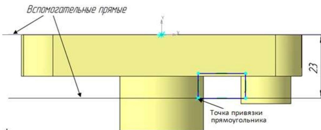
Рисунок 28 – Эскиз ребра жесткости
