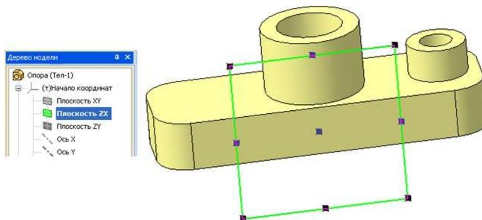
Рисунок 27 – Назначение плоскости для эскиза ребра жесткости
