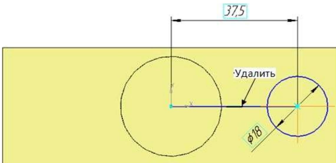
Рисунок 15 – Эскиз бобышки диаметром 18 мм
