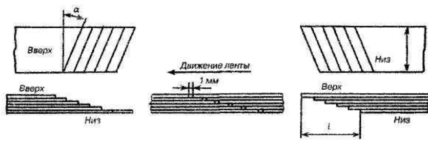
Рисунок 2.6 – Схема подготовки ленты к вулканизации
