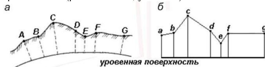
Рисунок 3.2. Вертикальный разрез (а) и профиль (б) местности
