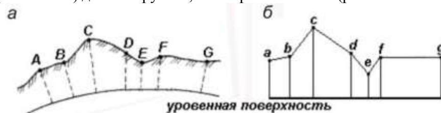
Рисунок 3.2. Вертикальный разрез (а) и профиль (б) местности
