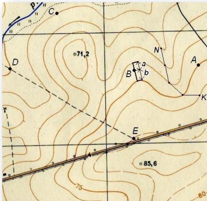
Рисунок 3. Определение отметок точек на карте с горизонталями
