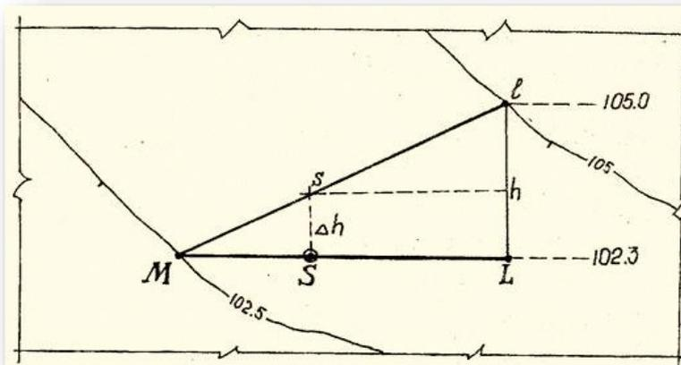
Рисунок 4. Определение отметки точки
