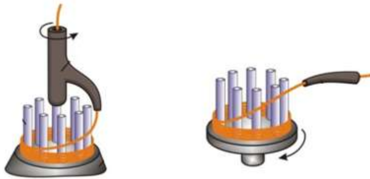
Рис. 9 - Мелкосортные (проволочные) моталки с бунтом: а — стационарным; б — вращающимся, в — общий вид; 1, 5 — трубки; 2 — палец; 3— плита; 4— грибовидный шпиндель; 6— катанка (проволока)
