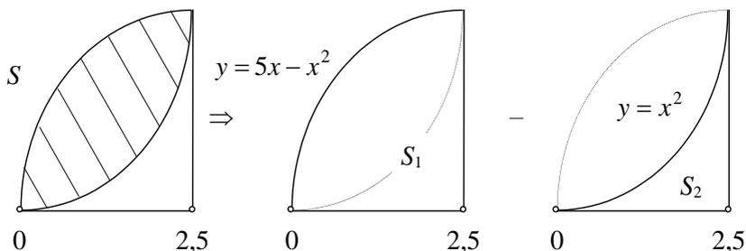
Следовательно, чтобы получить искомую площадь  $S$ , достаточно определить площадь  $S_1$  для функции  $y = 5x - x^2$  и вычесть из нее площадь  $S_2$  для функции  $y = x^2$ , т.е.
