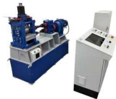
Рисунок 1 – Автоматизированный прокатный стан ДУО-130
