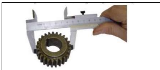
Рис.47 Определение диаметра вершин зубьев колеса
