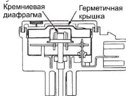
Рисунке 6. Конструкция датчика абсолютного давления (MAP)
