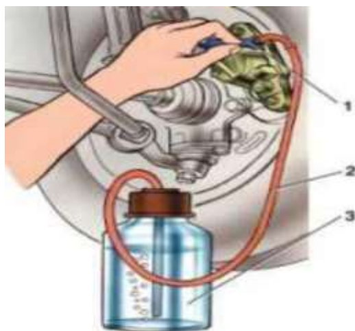
Рис. 2. Удаление воздуха из гидропривода тормозов: 1 - шпунцер для прокачки; 2 - шланг; 3 - сосуд с жидкостью
