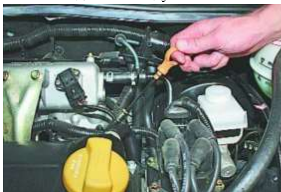
Рисунок 1- Проверка уровня масла в картере двигателя
