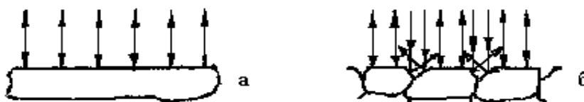
Рис. 7. Схема отражения световых лучей от поверхности полированного (а) и подвергнутого травлению (б) микрошлифа.
