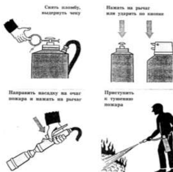
Рис.1. Приведение в действие воздушно-пенного огнетушителя.
