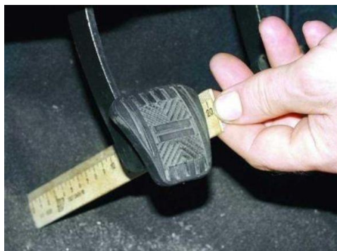
Рисунок 1- Проверка свободного хода педали сцепления
