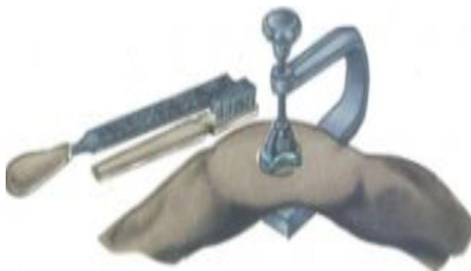
Рис. 1. Ремонт камеры автомобильного колеса
