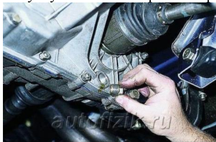
Рис. 2. проверка уровня масла в коробке передач
