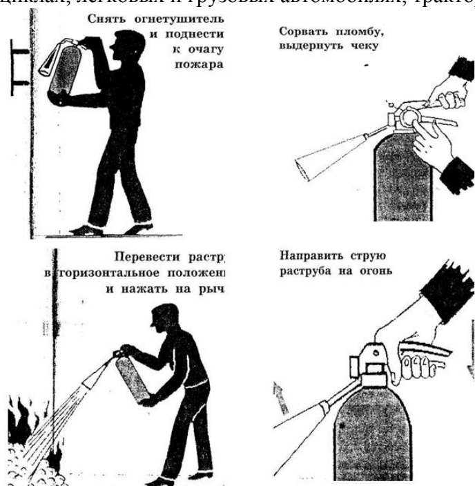
Рис. 3. Приведение в действие ручного углекислого огнетушителя.
