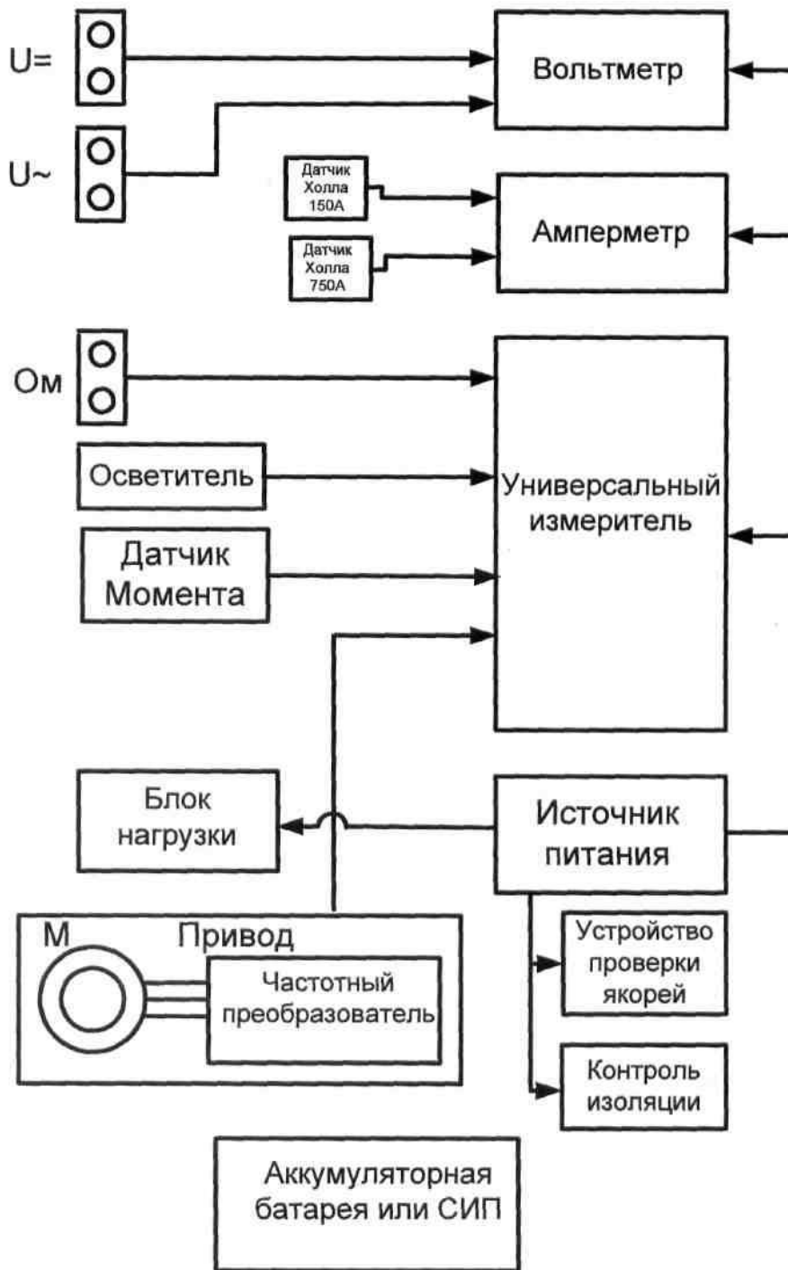
Рисунок 7. Схема электрическая функциональная стенда
