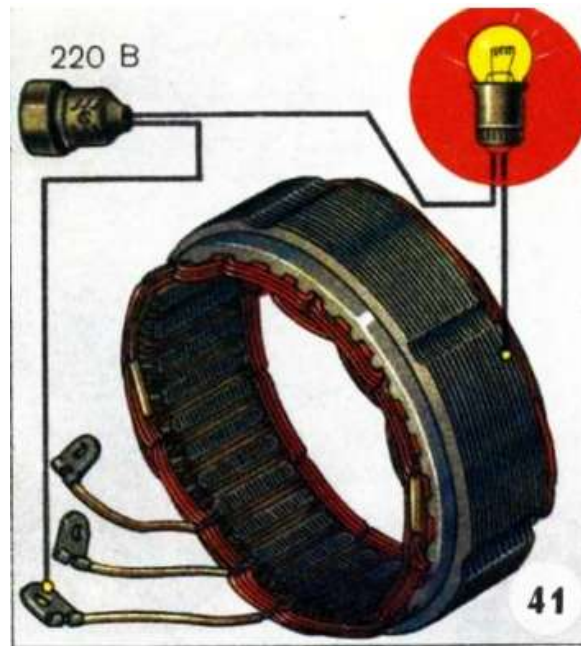
Рисунок 16 Проверка обмотки статора на замыкание с корпусом
