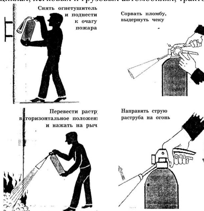
Рис. 3. Приведение в действие ручного углекислого огнетушителя.
