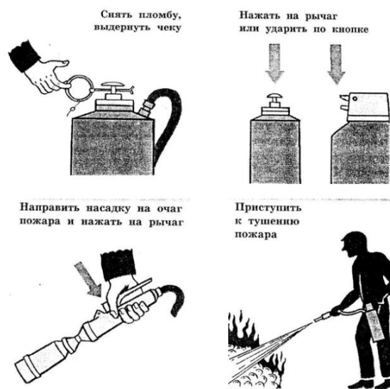
Рис.1. Приведение в действие воздушно-пенного огнетушителя.
