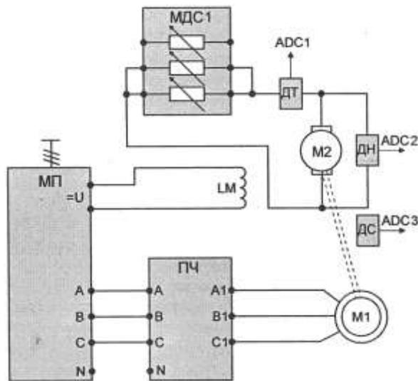
Рисунок 1.2. Схема для проведения опыта динамического торможения
