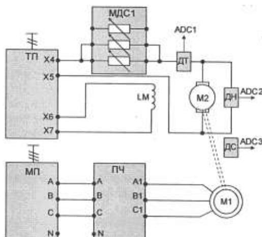
Рисунок 1.1. Схема для исследования двигателя независимого возбуждения
