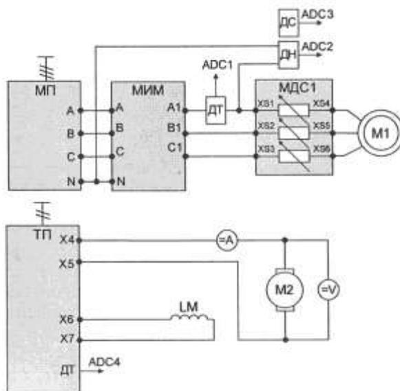
Рисунок 1 - Схема для исследования асинхронного двигателя
