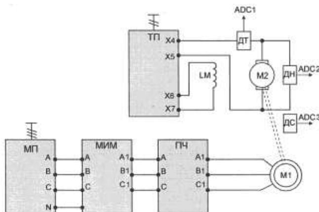
Рисунок 1 - Схема для снятия характеристик системы ПЧ-АД
