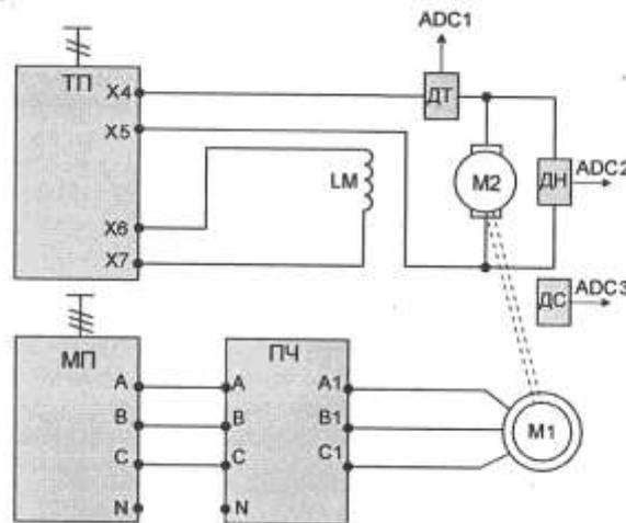
Рисунок 1.1. Схема для исследования двигателя независимого возбуждения
