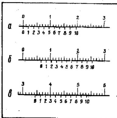
Рисунок 3 – Положение шкал штангенциркуля при отсчете размеров:
