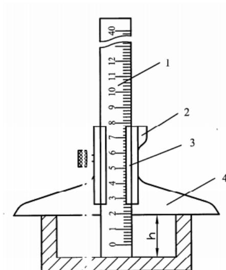
Рисунок 4 – Устройство штангенглубиномера
