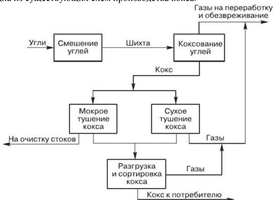
Рис. 1 – Технологическая схема производства кокса
