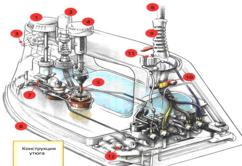
Рис.2 Конструкция утюга
