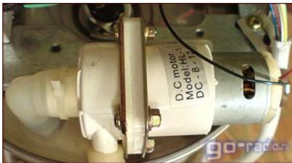
Рис.3 Двигатель водяной помпы
