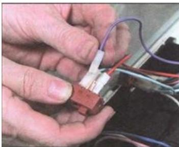
Рис.5 Проверка выключателя
