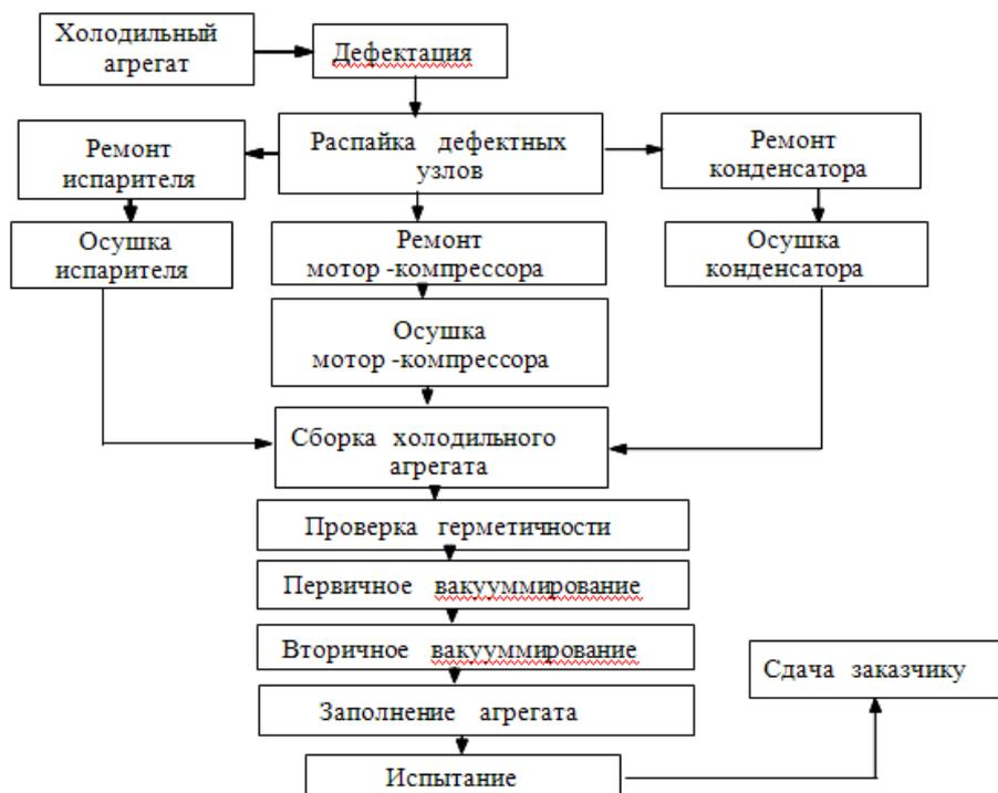
Рис. 1 Технологическая схема ремонта компрессионного холодильного агрегата
