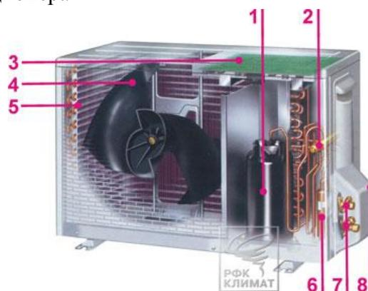
**Компрессор** — сжимает фреон и поддерживает его движение по холодильному контуру. Компрессор бывает поршневого или спирального (scroll) типа. Поршневые компрессоры дешевле, но менее надежны, чем спиральные, особенно в условиях низких температур наружного воздуха.
