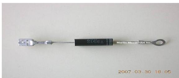
Рис. 3 Высоковольтный диод СВЧ печи
