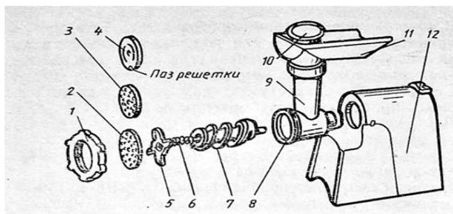
Рис. 1 - Шнековая мясорубка:
