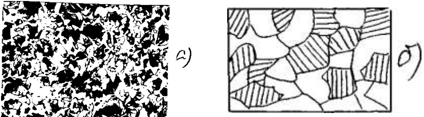
Рис. 4.2. Микроструктура (а) и ее схема (б) стали 30ХГСА после отжига
