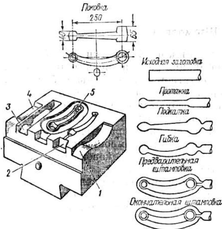
Рис.10 Схема многоручьевого штампа: 1-верхний штамп; 2-нижний штамп
