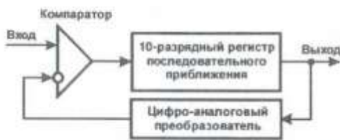
Рис. 1. Структура АЦП последовательного приближения
