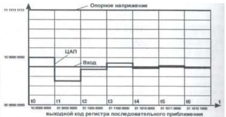
Рис. 2. Принцип работы АЦП последовательного приближения
