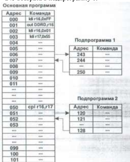
Рис. 1. Принцип работы указателя стека
