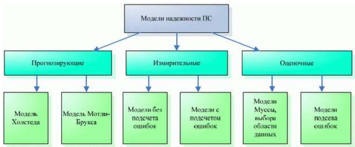
Рис. 1. Классификация моделей надежности
