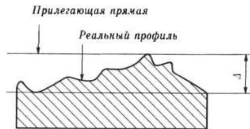
Рис. 4.1 Прилегающая прямая и реальный профиль
