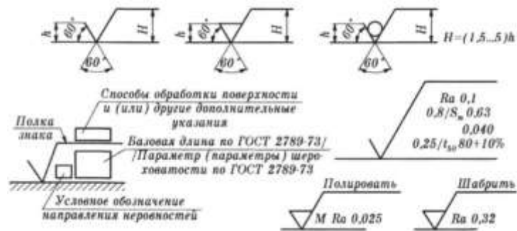
Рисунок 2 – Обозначения шероховатости поверхности
