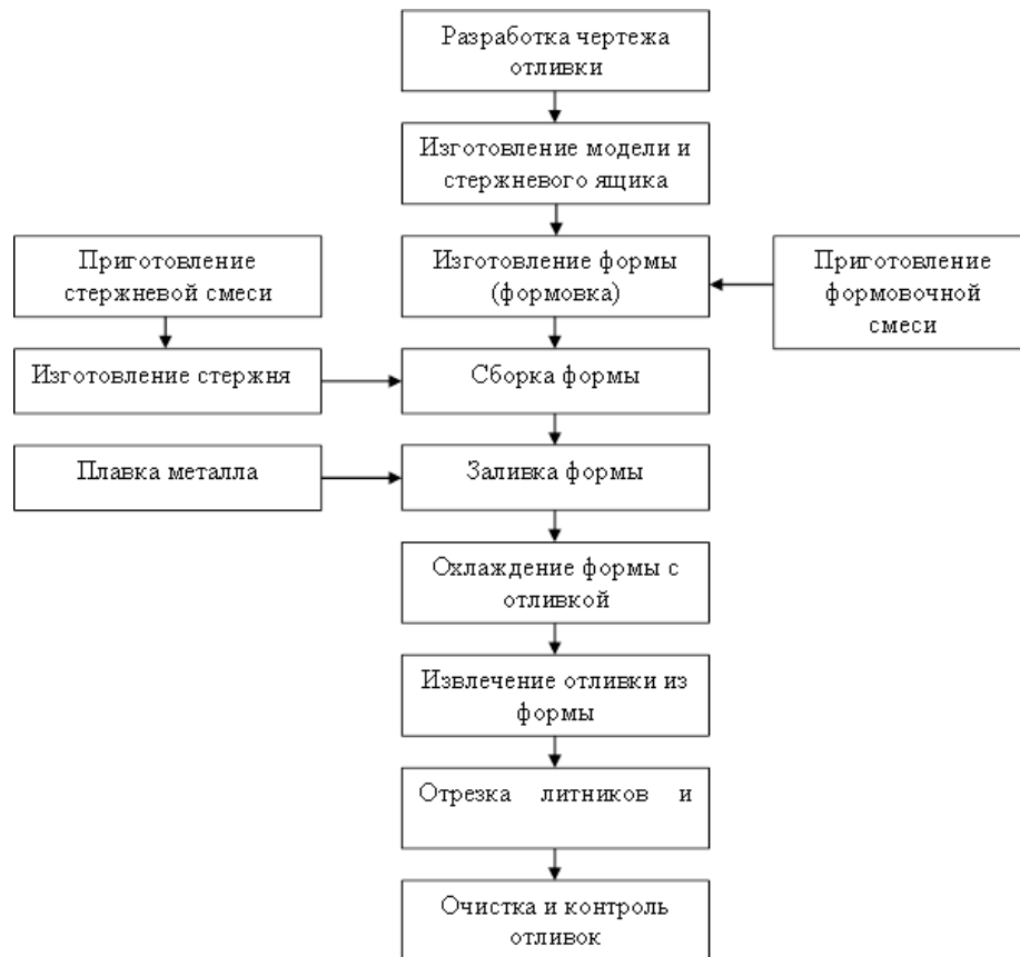
Рисунок 1 – Схема технологического процесса изготовления отливок
