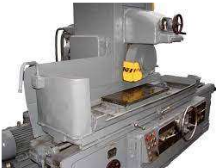
3Б722 станок плоскошлифовальный с горизонтальным шпинделем универсальный
