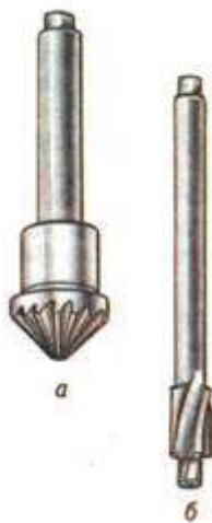
Рис. 1. Зенковки: а - коническая; б - цилиндрическая.
