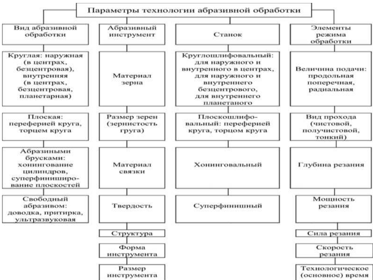
Рис.1. Схема параметров технологии абразивной обработки
