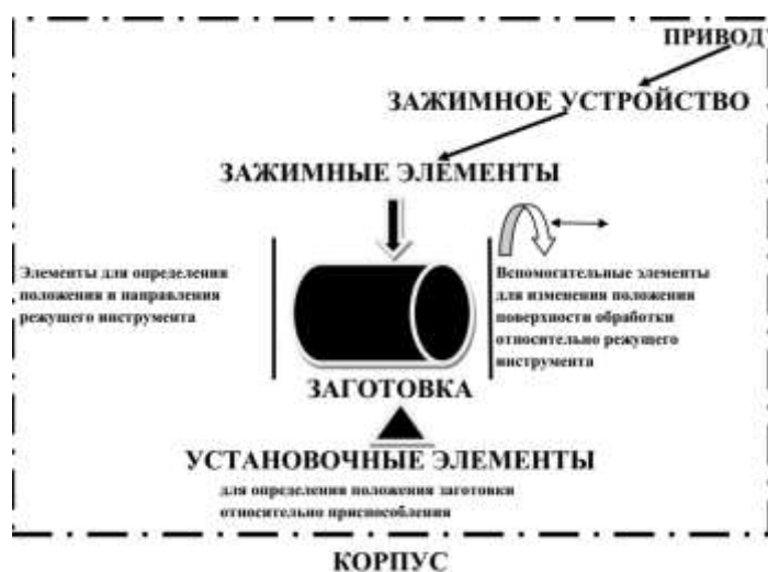
Рис. 1. Структура станочного приспособления
