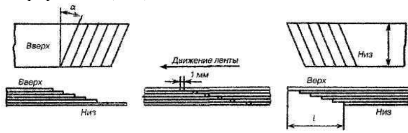
Рисунок 2.6 – Схема подготовки ленты к вулканизации
