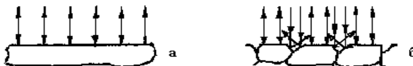
Рис. 7. Схема отражения световых лучей от поверхности полированного (а) и подвергнутого травлению (б) микрошлифа.
