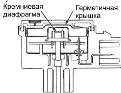
Рисунке 6. Конструкция датчика абсолютного давления (MAP)
