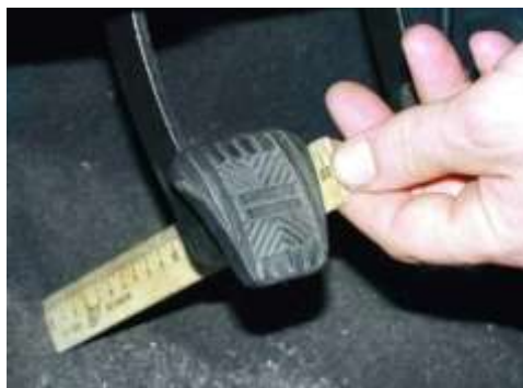
Рисунок 1- Проверка свободного хода педали сцепления
