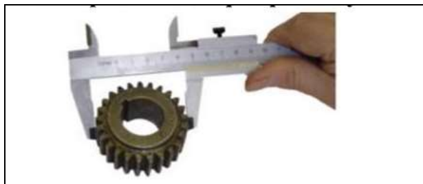
Рис.47 Определение диаметра вершин зубьев колеса
