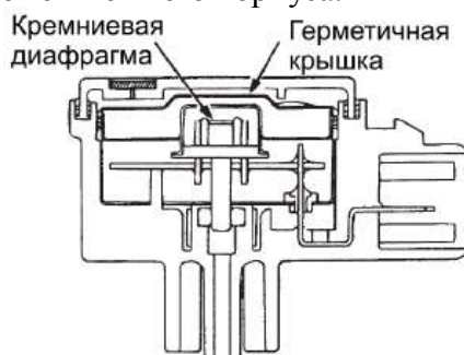
Рисунке 6. Конструкция датчика абсолютного давления (MAP)
