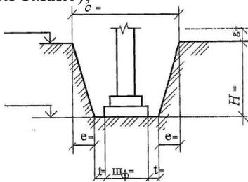
$$H = H_{\text{заложения}} - H_{\text{уров. земли}} - H_{\text{срезки}}$$
