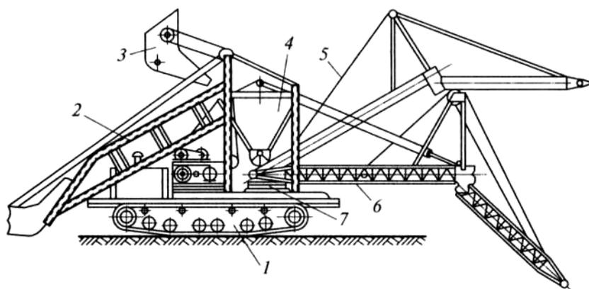
Рисунок 3. Самоходный бетоноукладчик.
