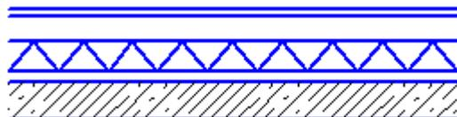
Стяжки выполняют из цементно-песчаного раствора марки 50-100 или из мелкозернистого асфальтобетона. Летом используют цементно-песчаную стяжку, в зимнее время асфальтобетон. Толщина стяжки составляет: 10-15 мм для бетона, 20-25 мм для плитного утеплителя, 25-30 мм для сыпучих и не жёстких плитных утеплителей.
