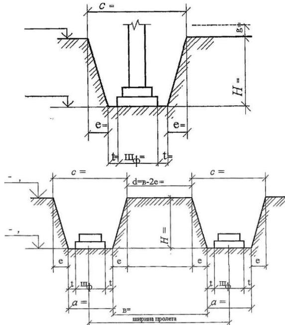
**- определить объём грунта, разрабатываемого под фундаменты для перегородок:**
