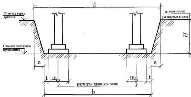
По формуле Н. Симсона определяем объём данного земляного сооружения:
