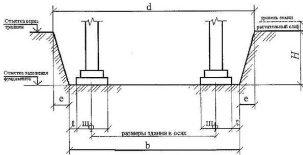
$$b = z + \text{---} u_{\phi} + \text{---} u_{\phi} + 2t$$
