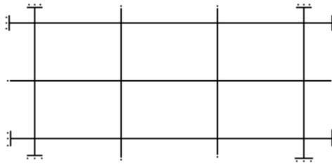
После этого вокруг будущего земляного сооружения на расстоянии 2-3м от его бровки параллельно основным разбивочным осям устанавливают обноску.
