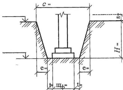
$$H = H_{заложения} - H_{уров. земли} - H_{срезки} \quad \text{м};$$
