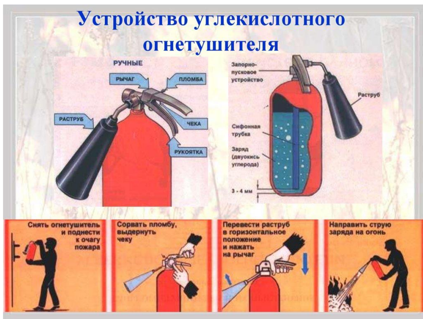
рис.2 Углекислотный огнетушитель
