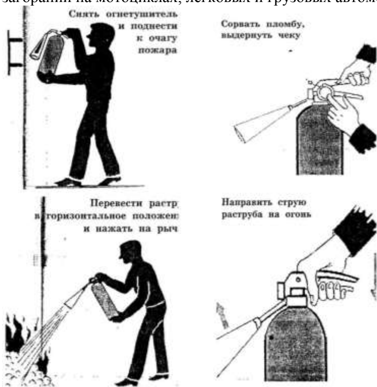
Рис. 3. Приведение в действие ручного углекислого огнетушителя.
