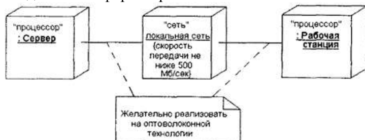
Рис. 3. Фрагмент диаграммы развертывания с соединениями между узлами
