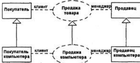
Рис. 2. Графическое изображение отношения обобщения между отдельными кооперациями уровня спецификации
