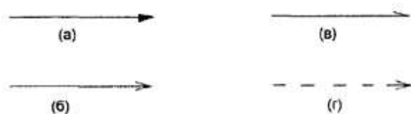
Рис. 7. Графическое изображение различных типов сообщений на диаграмме кооперации
