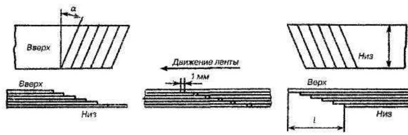
Рисунок 2.6 – Схема подготовки лены к вулканизации
