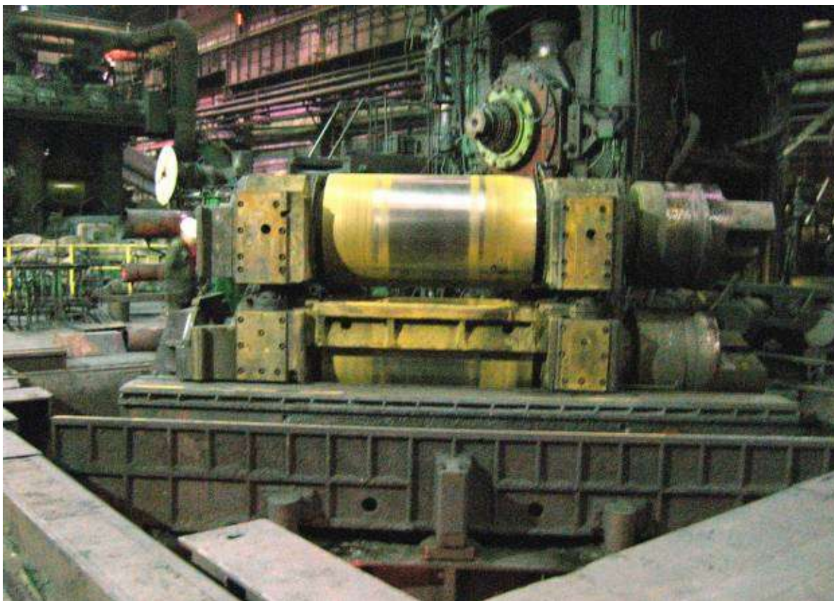
Рис.2. Поворот перевалочной платформы черновой группы
