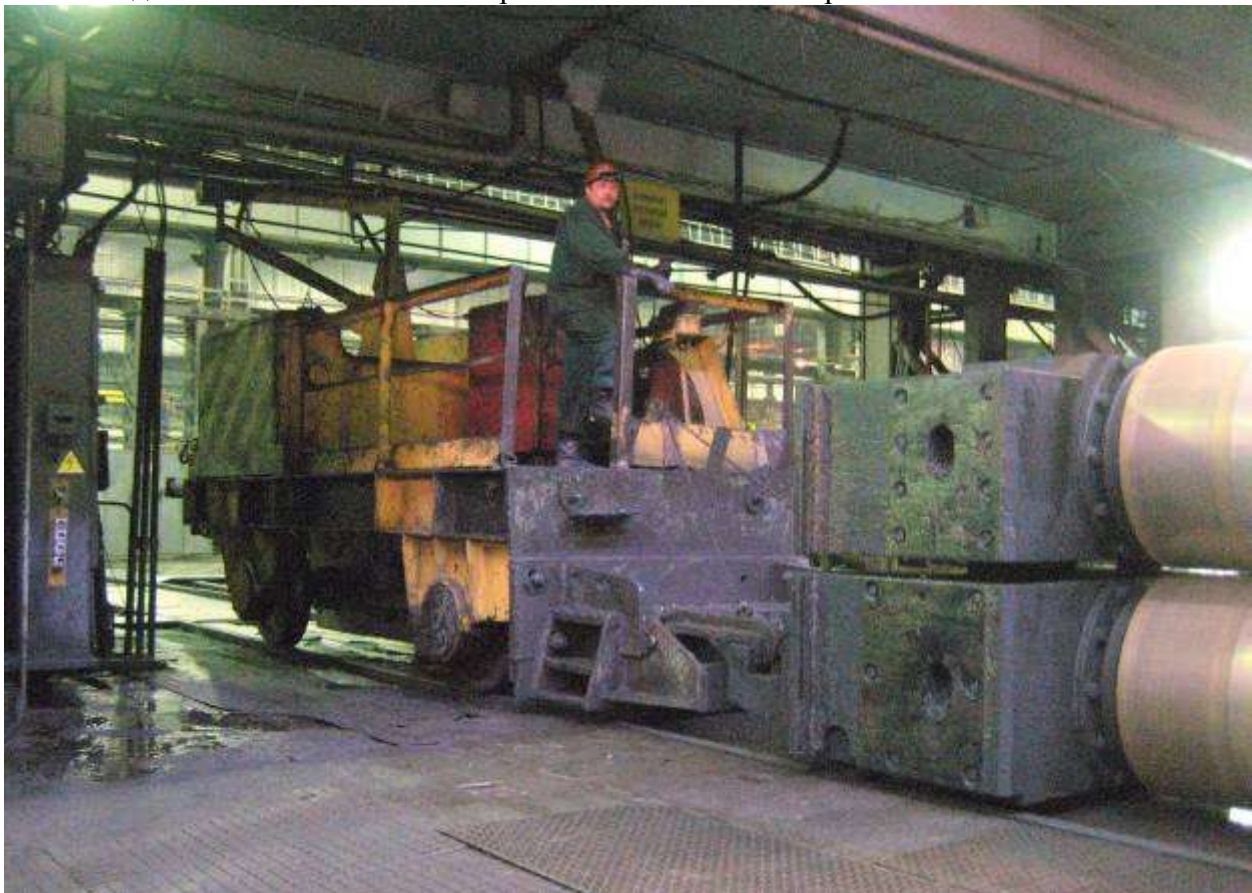
Рис.3. Подготовленный комплект вертикальных валков к перевалке
