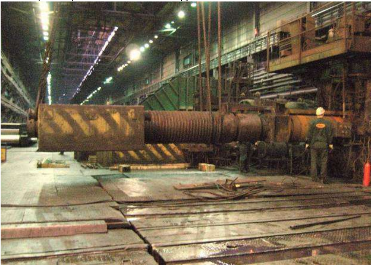
Рис.7. Перевалка валка чистового окалиноломателя при помощи муфты
