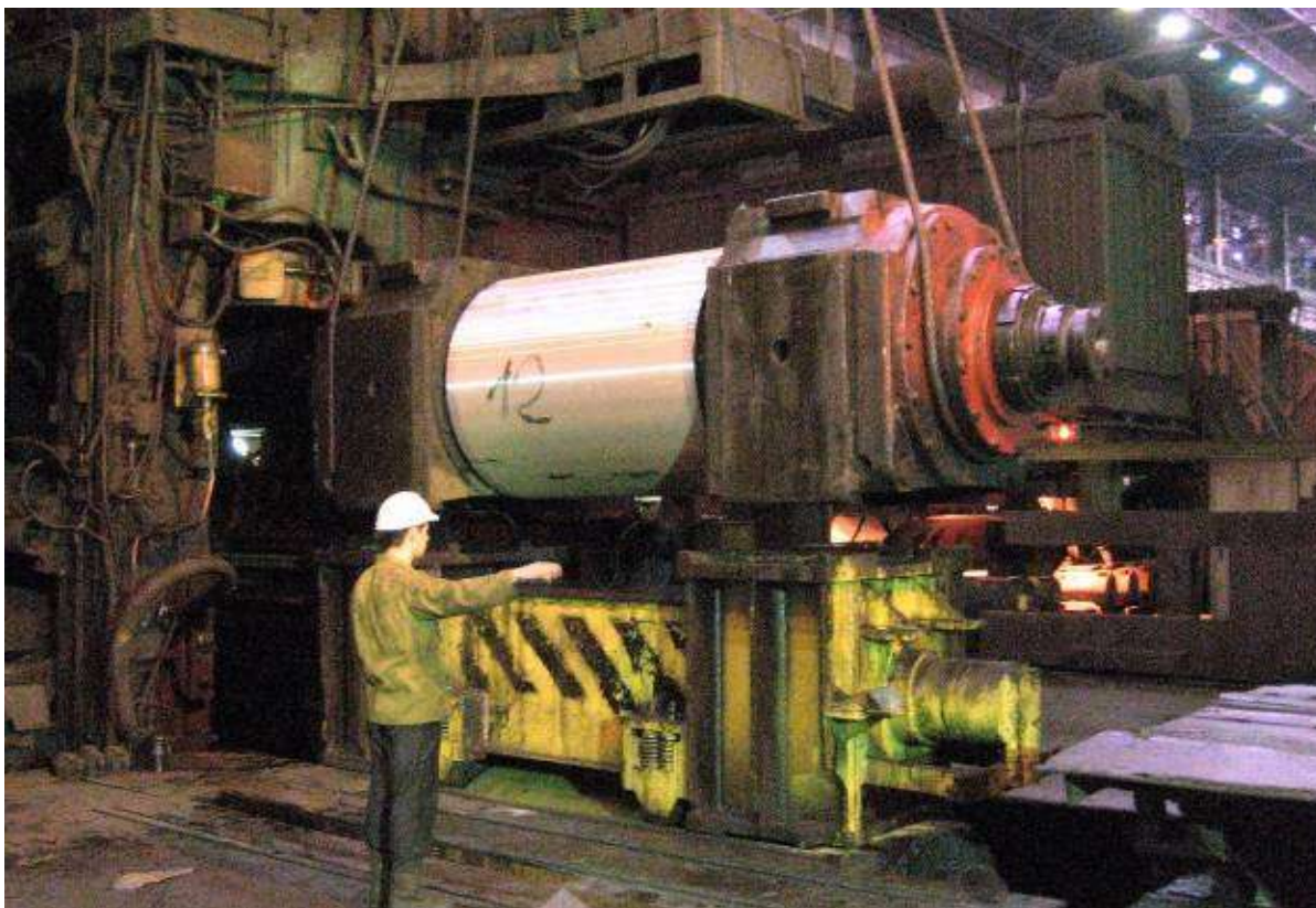
Рис.8. Перевалка верхнего опорного валка с применением вставки
