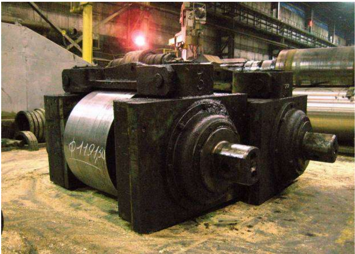
Рис.3. Подготовленный комплект вертикальных валков к перевалке
