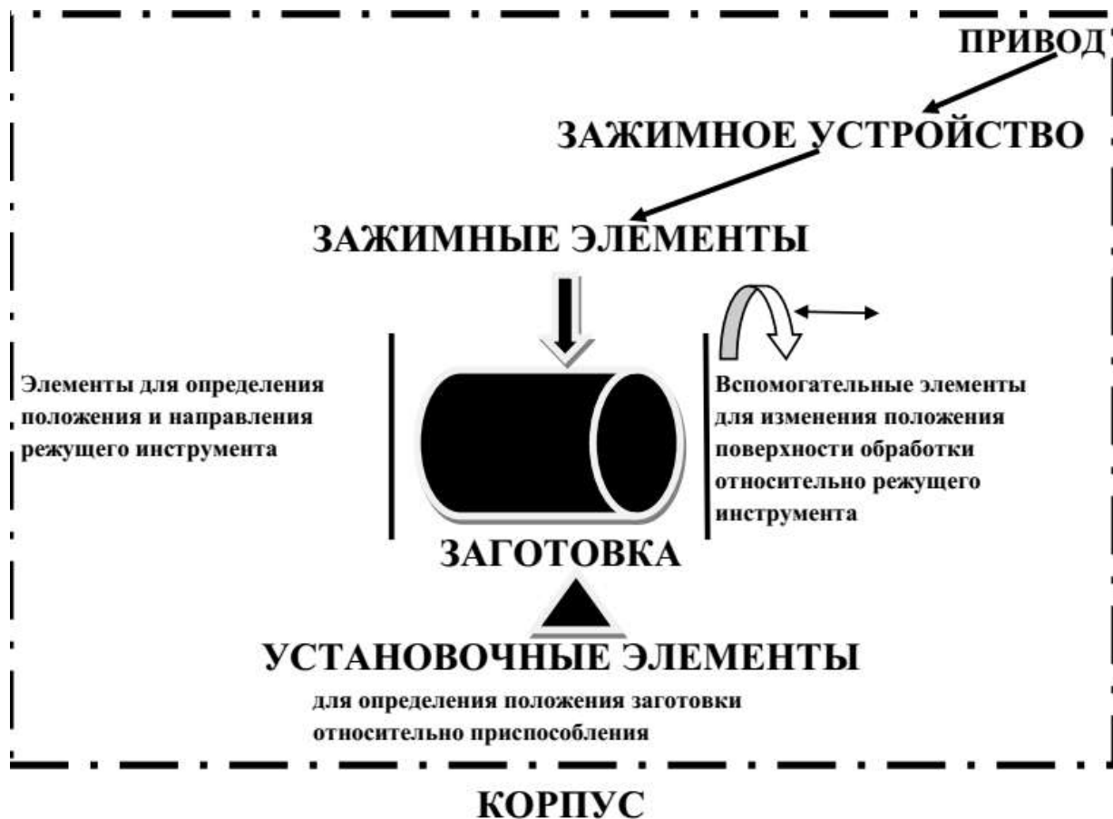
Рис. 1. Структура станочного приспособления
