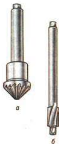
Рис. 1. Зенковки: a - коническая; б - цилиндрическая.
