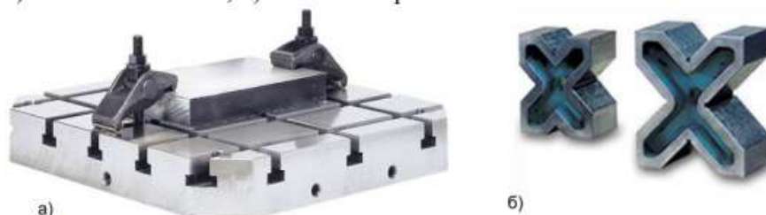
Рис.6 Приспособления а) Закрепление прихватами, б) призмы
