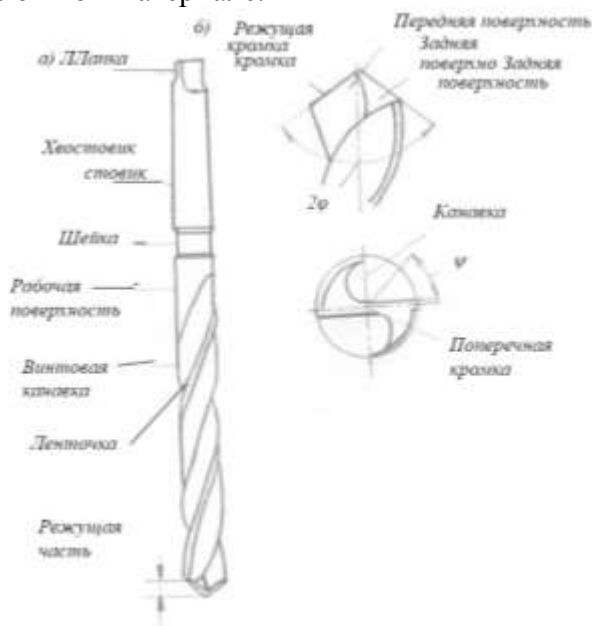
Рис.1. Части и элементы спирального сверла
