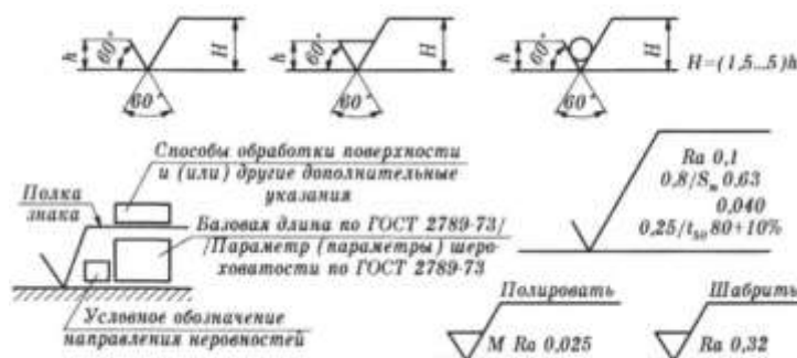
Рисунок 2 – Обозначения шероховатости поверхности
