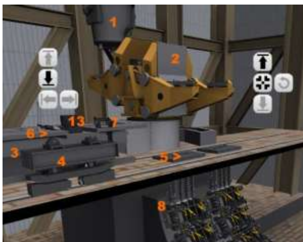
Рисунок 2 - Устройство МНЛЗ: площадка разливки стали
