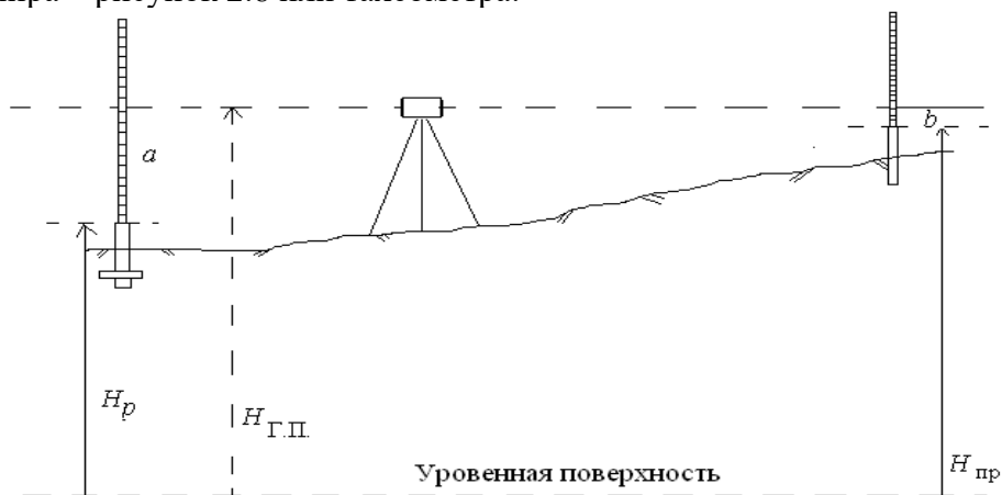
Рисунок 2.8. Вынос проектной отметки на местность с помощью нивелира.
