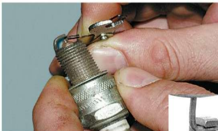
Рис. 56.1. Проверка зазора между электродами свечи с помощью круглого проволочного щупа
